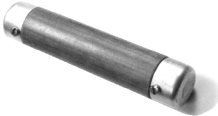
Предохранители плавкие типа НПР1 и НПР2 предназначены для защиты аккумуляторных батарей и низковольтных цепей вагонов метрополитена и трамвайных вагонов с номинальным напряжением по стоянному току 550 В и 750 В.
